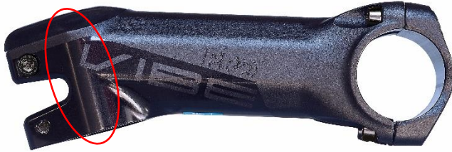
图 2：前叉立管的夹钳区域会出现裂纹。
